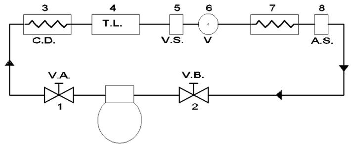
Considerando-se a necessidade de troca do componente 6, especificado na figura acima, qual a sequência de procedimentos correta para não haver a perda do fluido refrigerante no circuito?
